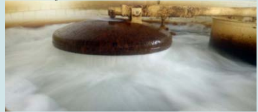
Figure 176 - Dissipation de la pression hydraulique à l'aide d'une soupape de sécurité
